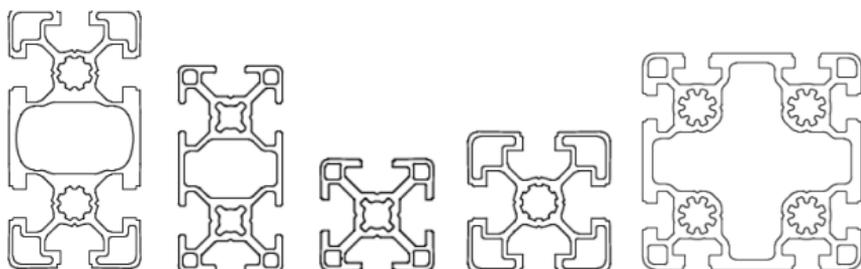
Aluminium Maschinenbauprofile/Nutprofile, I-Typ, leicht, E6/EV1, HL 6000 mm
